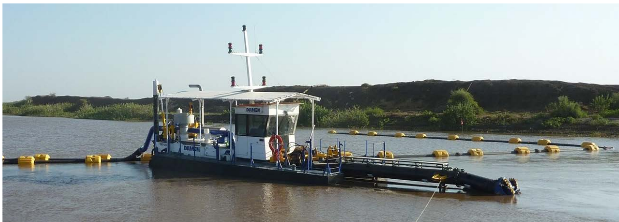
Figur 3-9: Cuttersuger monteret på flåde med pumpestation og jordspyd for fastholdelse under arbejdet
