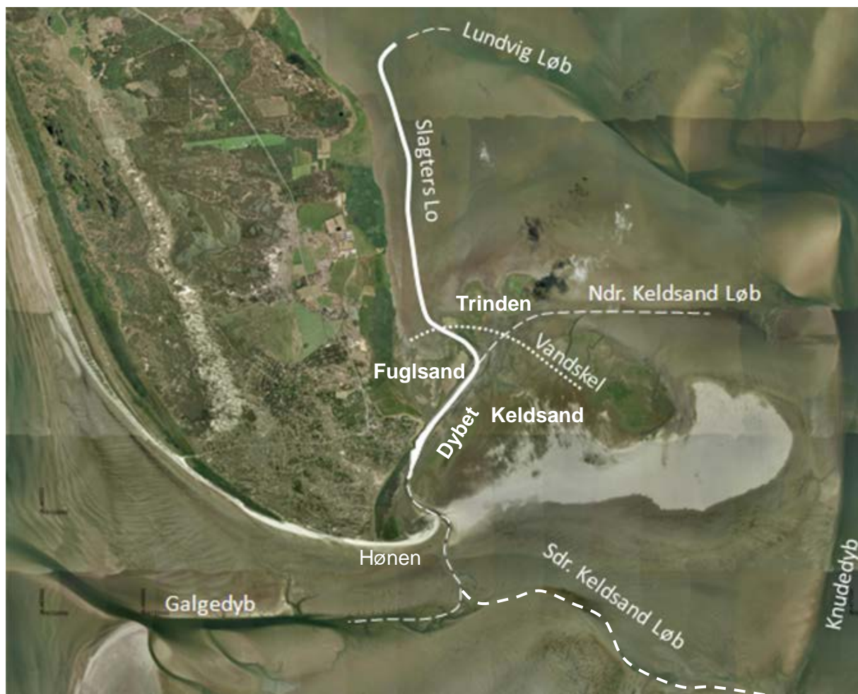
Figur 2-3: Ved uddybning af Slagters Lo gennemskæres vandskellet ved Fuglsand
